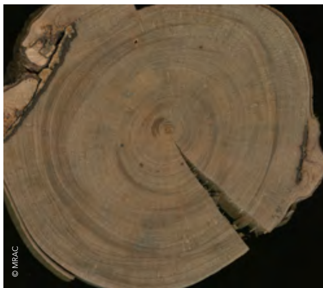
Le projet « SmartWoodID » compile une base de données d'images d'échantillons congolais provenant du xylarium de Tervuren. Ces images sont utilisées pour identifier le bois sur la base de caractéristiques macroscopiques en utilisant l'intelligence artificielle. Sur la photo : Prioria balsamifera (tola).
