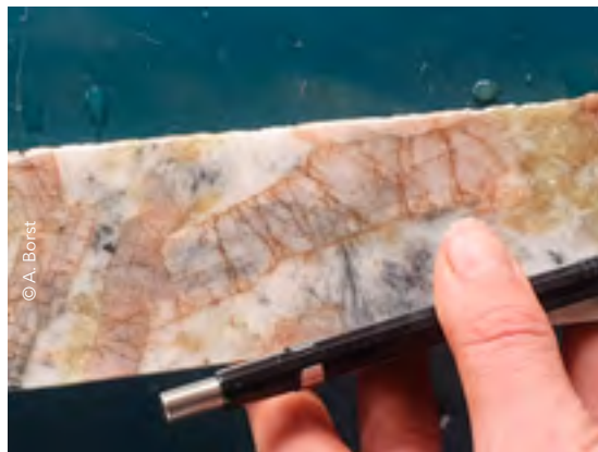
Carotte d'une pegmatite riche en spodumène (minéral de lithium) provenant de Piran Rwanda Ltd opérant dans la région de Musha et Ntunga, au Rwanda.
