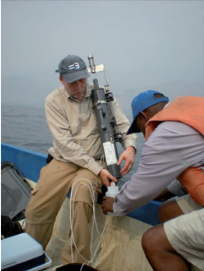
Prélèvement d'eau à l'aide d'une bouteille Niskin pour l'échantillonnage limnologique à Uvira (équipe du Centre de Recherche hydrobiologique et Pierre-Denis Plisnier). La concentration de l'eau en chlorophylle servira notamment à la calibration des mesures effectuées par satellite pour étudier les émergences phytoplanctoniques. © MRAC
