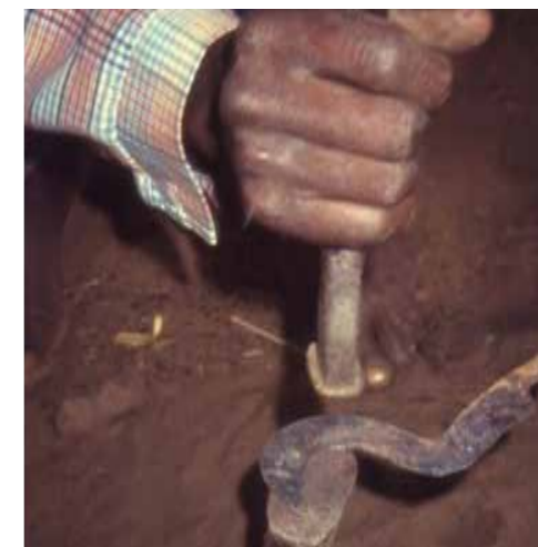
Marteau positionné verticalement et utilisé comme enclume.
