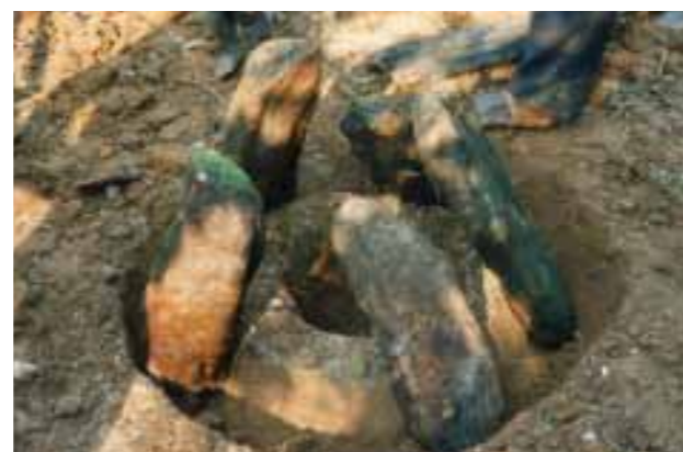
4. Fourneau prêt à être alimenté en charbon de bois.
