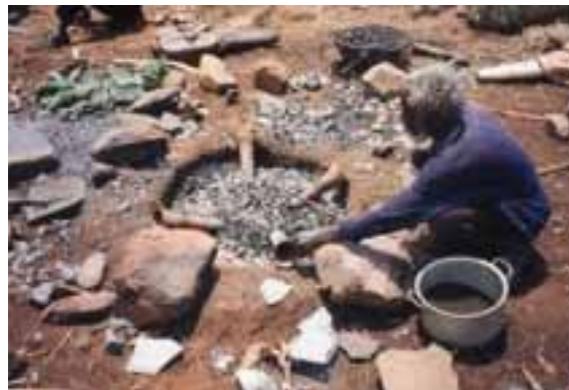
8. Le fourneau est à nouveau chargé de charbon de bois et de minerai concassé.
