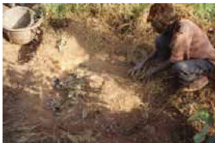
La fosse est découverte après environ 24 heures de combustion souterraine.
