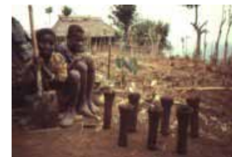
Tuyères récemment fabriquées et mises à sécher.
