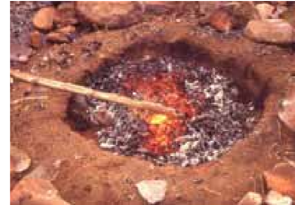
14. Extraction de la loupe hors du fourneau.
