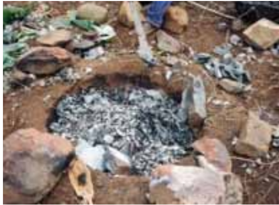
6. Le fourneau est démonté, le minerai en est ensuite extrait.
