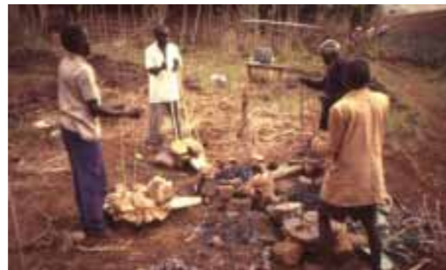
11. Les soufflets alimentent le fourneau en air.
