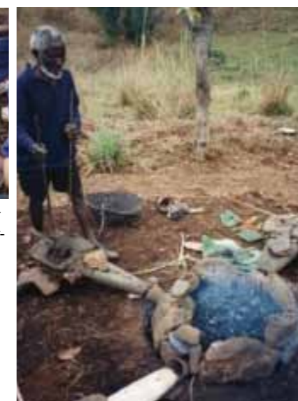
5. Le minerai est grillé.
