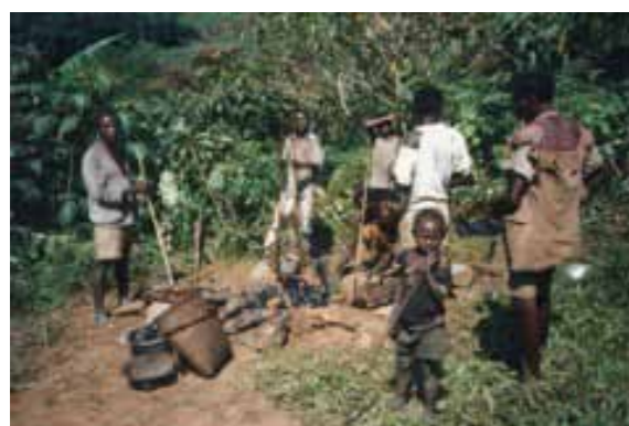
7. Le fourneau est alimenté en air en actionnant les soufflets.
