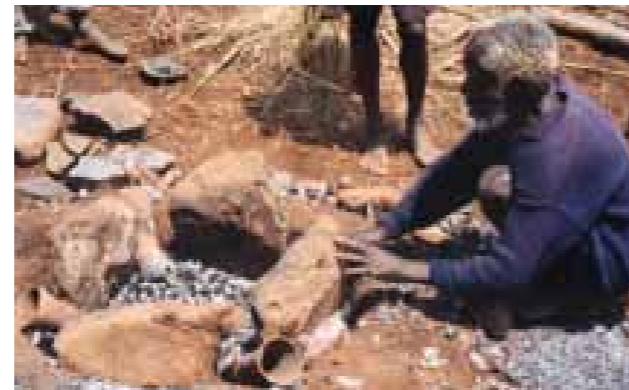
9. Les parois du fourneau sont montées pour la seconde fois.
