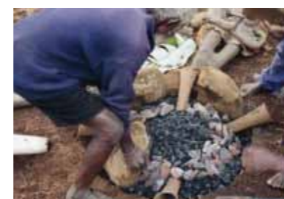
4. Des blocs de minerai sont disposés sur le charbon de bois, puis les parois du fourneau sont montées.
