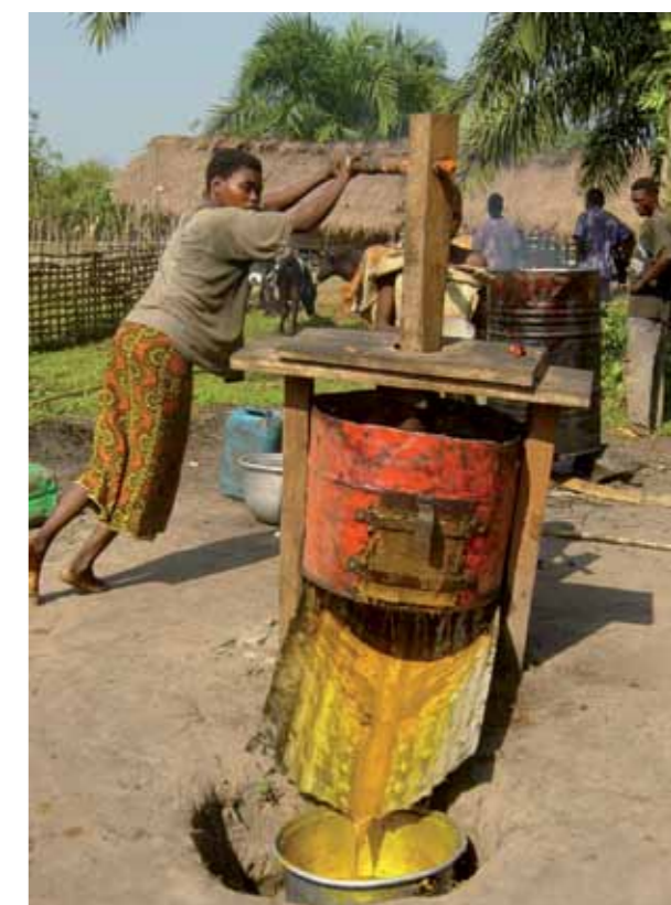
Ill.21.18. Femme extrayant l'huile de palme à l'aide d'un malaxeur-pressé artisanal. En arrière-plan, un fût dans lequel sont chauffés les régimes. (Photo CDI-Bwamanda/Heverlee, 2003.)
